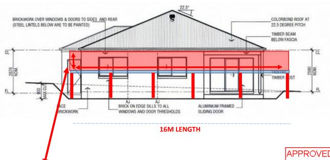
9 DEGREES OF FALL FROM EXISITING GUTTER HEIGHT (2676MM)
