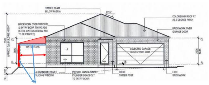
EXTERNAL GUTTER HEIGHT & POST HEIGHT - 2450MM
